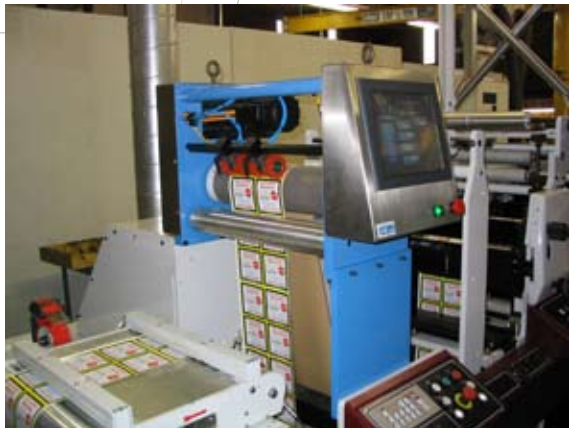
Registrando en bandas pre-impresas dobla la capacidad de colores y conversion de su prensa. Foto en prensa Mark Andy LP3000.
