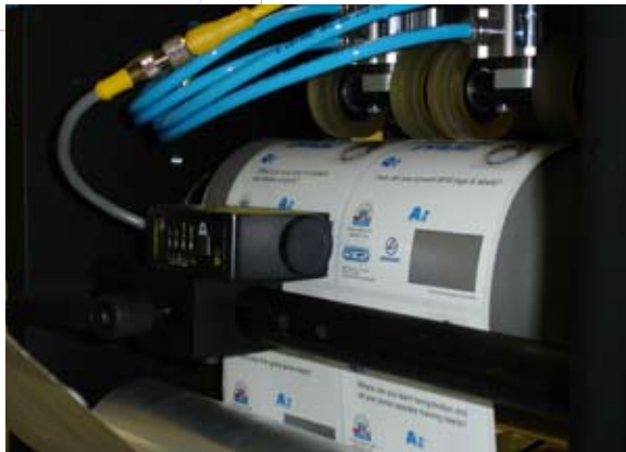
Una vista del cilindro recubierto de alimentacion con sus ruedas de agarre para prevenir deslizamiento de la banda. Tambien se ve el sensor de lectura.
