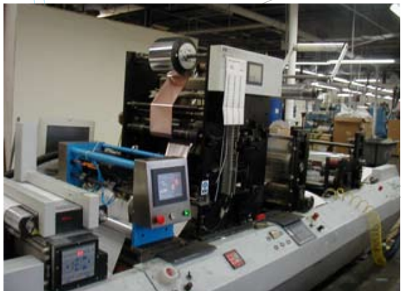
El Servo 3000 puede ser integrado como un sistema de registración en equipos de conversión. Foto en prensa de estampado de foil en caliente.
