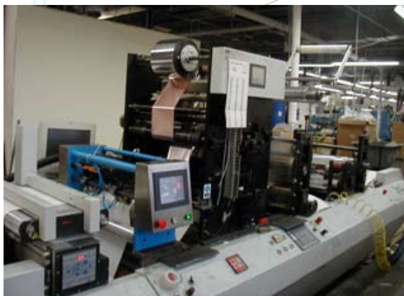
Die Servo 3000 kann als Registrierungssystem für jede übliche Umstellausrüstung integriert werden. Aufbau auf einer Hot Foil Stamp Presse
