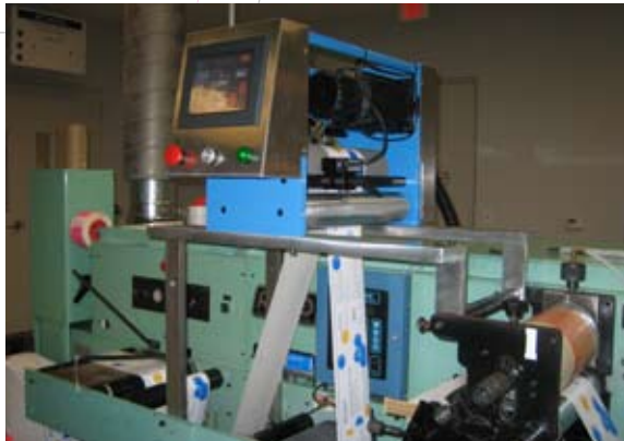
Rollen die auf einer HP Indigo, oder einer anderen digitalen Presse bedruckt wurden, können auf Ihre existierende Presse umgestellt werden. Aufbau auf einer Rotopress 3513.
