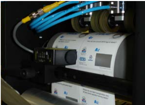
Nahansicht der ummantelten Geschwindigkeitsrollen und Greifräder die das Durchrutschen verhindern. Es wird auch der Druck Positionssensor gezeigt.
