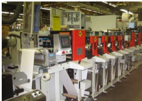
Die Servo 3000 ist eine echte Pressen Aufwertung, egal welcher Hersteller oder wie alt die Presse ist. Aufbau auf einer Aquaflex ELS Servo Presse.
