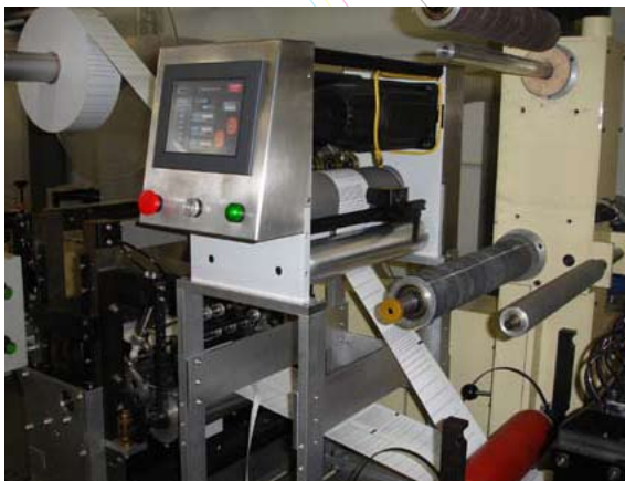
Die Servo 3000 kann eine 2. vorbedruckte Rolle zur Rolle, die bereits in der Maschine läuft verschieben. Aufbau auf einer Gallus EM 340
