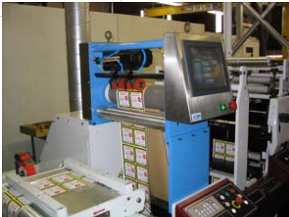
Verschieben einer vorbedruckten Rolle, verdoppelt die Farben auf der Presse und die Umstellkapazität. Aufbau auf einer Mark Andy LP 3000
