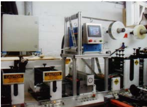
Laminieren von vorbedruckter Rolle ist eine einfache Möglichkeit Kupons, Booklet und Teile für Spiele herzustellen. Aufbau auf einer Aquaflex InstaPrep
