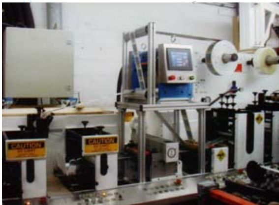
Het lamineren van een voorbedrukte baan is een simpele manier om coupons, booklets en andere meerlagen producten te maken. Zoals hier op een aquaflex InstaPrep.
