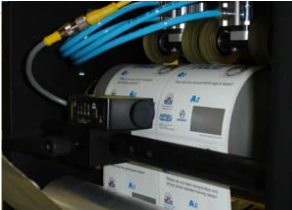
Een detail foto van de beklede wals en de aandrukrollen die samen slip voorkomen. Op de foto is ook de drukmerk sensor te zien.
