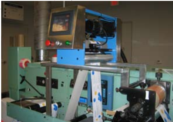
De op een HP Indigo digitaal gedrukte rollen Worden afgewerkt op een bestaande Rotopress 3513 met Servo3000.
