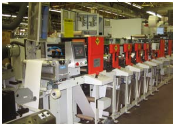
De Servo3000 is een uitbreiding die op elk merk of type drukpers geplaatst kan worden, hier op een Aquaflex ELServo pers.
