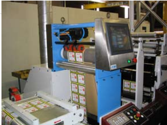
Het in register invoeren van een bedrukte baan waardoor twee keer zoveel kleuren kunnen worden gedrukt, hier op een Mark Andy LP3000.
