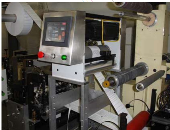
De Servo3000 brengt een bedrukte baan in perfect registeraan op een baan die op dat moment gedrukt wordt, zoals hier op een Gallus EM 340.
