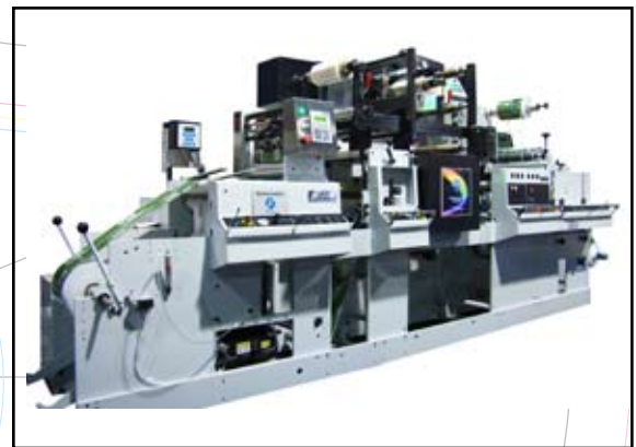
Een verbouwde Mark Andy + Servo3000 maken samen een betaalbare digitale afwerkingslijn.
