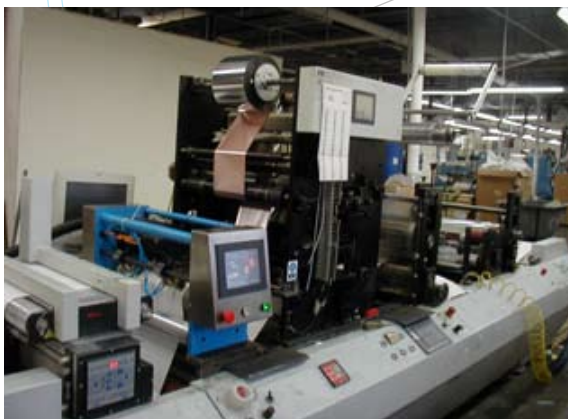
De Servo3000 kan geïntegreerd worden op spe- ciaalmachines of afwerkingsmachines. Hier op een hot-foil machine.
